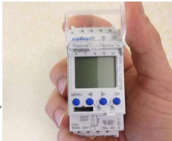
Salbris a investi dans l'achat de 31 horloges astronomiques de ce type et mis en place un éclairage public semi-permanent afin de réduire la consommation énergétique d'environ 30 %.
